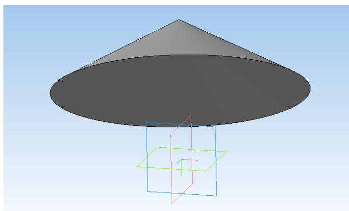
14. Выбрать нижнюю грань (внутреннее основание) зонтика и создать смещенную плоскость 1 на расстоянии 0 мм.
