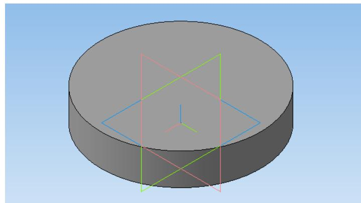
11. Выбрать верхнюю грань цилиндра и создать смещенную плоскость 1 на расстоянии 0 мм.
