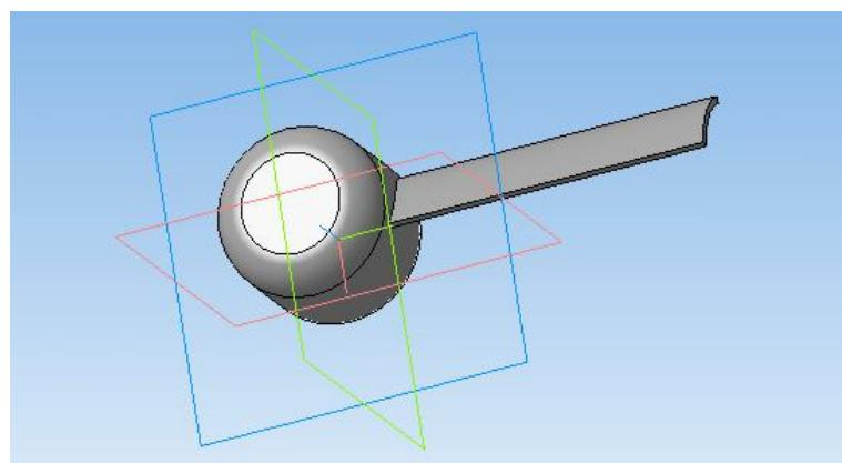
22. На панели редактирования детали выбрать **Массив по концентрической сетке**.
