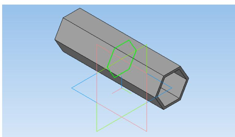
11. Выбрать на модели призмы нижнюю грань и создать смещенную плоскость 1 на расстоянии 0 мм.
