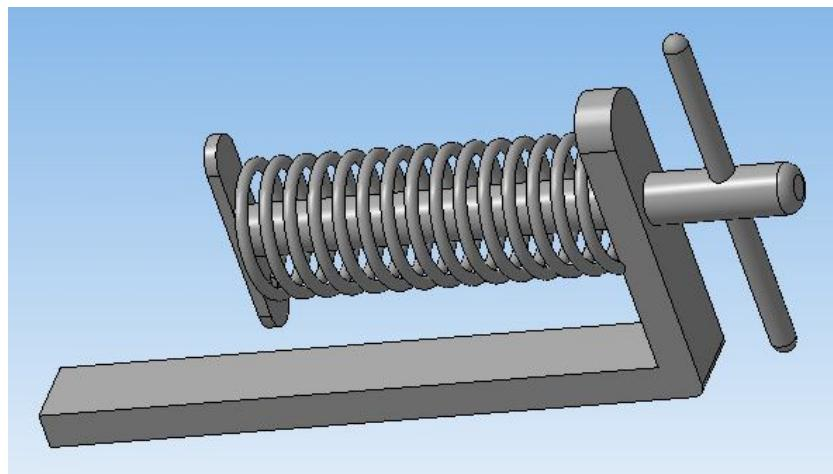
60. Выберете левую грань корпуса и выберете команду в вкладке **Вспомогательная геометрия Смещенная плоскость**. Установить следующие параметры: направление смещения – прямое; расстояние –0 мм. Нажать кнопку **Создать объект**.
