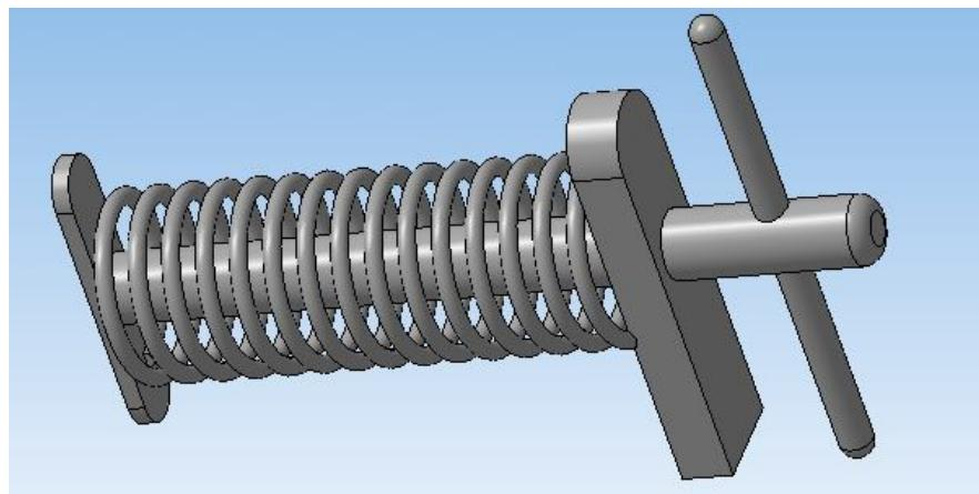
53. Выберете нижнюю грань корпуса и выберете команду в вкладке **Вспомогательная геометрия Смещенная плоскость**. Установить следующие параметры: направление смещения – прямое; расстояние –0 мм. Нажать кнопку **Создать объект**.
