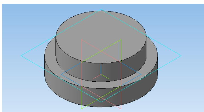
18. Аналогичным образом (повторяя операции добавить смещенную плоскость и создать цилиндр) построить цилиндры с параметрами: высота 20 мм; диаметр 60мм, 40мм, 20 мм.
