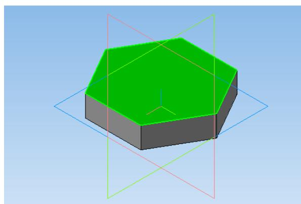
11. Выбрать команду в вкладке **Вспомогательная геометрия Смещенная плоскость**. Установить следующие параметры: направление смещения – прямое; расстояние – 0 мм. Нажать кнопку **Создать объект**.
